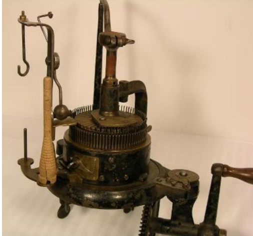
Slika 40.: Griswold-ov stroj za pletenje čarapa
