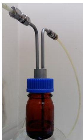
Slika 22. Reagens boca s nastavcima ( engl. bubbler bottle )
