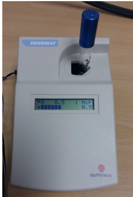
Slika 26. Priprema gustoće bakterijske suspenzije po McFarland standardu
