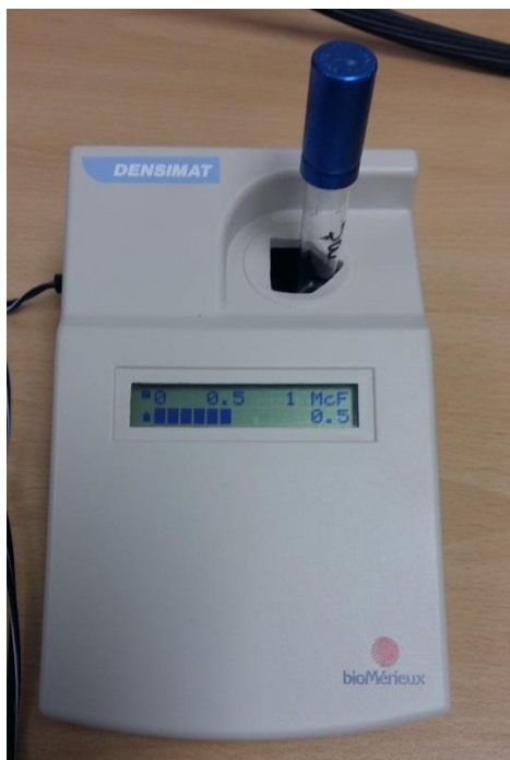
Slika 26. Priprema gustoće bakterijske suspenzije po McFarland standardu
