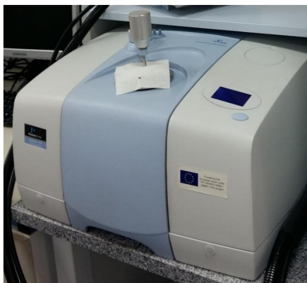
Slika 25. Spektrofotometar Spectrum 100S FT-IR, Perkin Elmer (USA)
