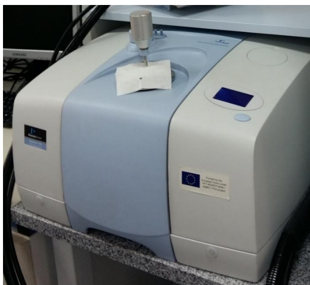
Slika 25. Spektrofotometar Spectrum 100S FT-IR, Perkin Elmer (USA)
