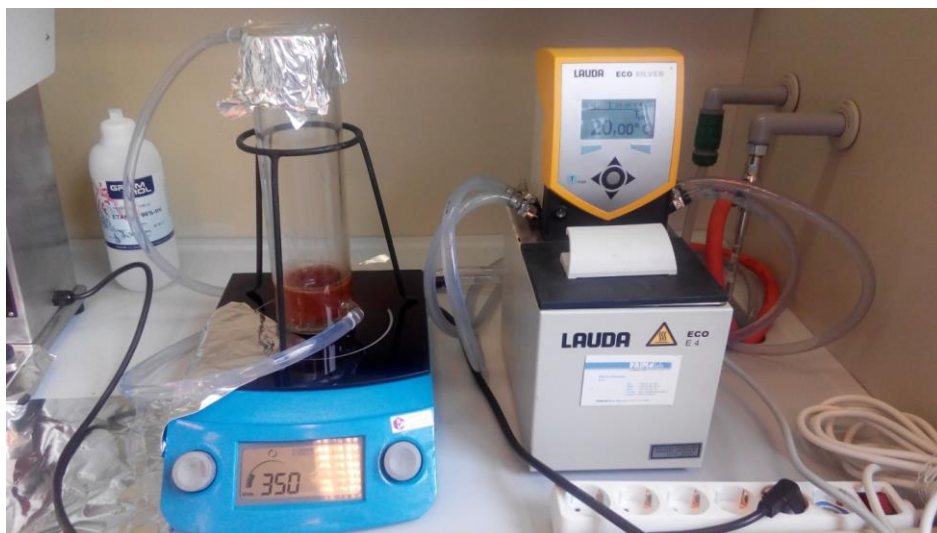
Slika 10: Aparatura za pripremu sol gel-prevlaka (Zavod za materijale, vlakna i ispitivanje tekstila)
