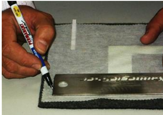
Sl.29 Označavanje krajeva naprave za mjerenje postotka skupljanja frontalno fiksiranog uzorka [26]
