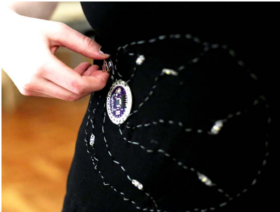
Sl.28 Ušivene sve komponente u body
