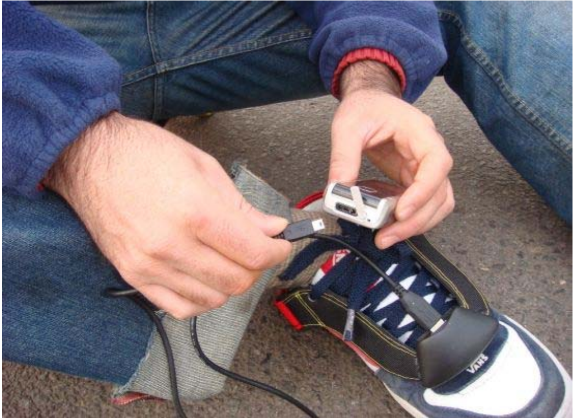
Sl. 13 Prototip tenisice s punjačem za mobitel
