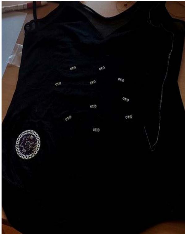
Sl. 24 Raspored svjetlećih dioda na body podlogu
