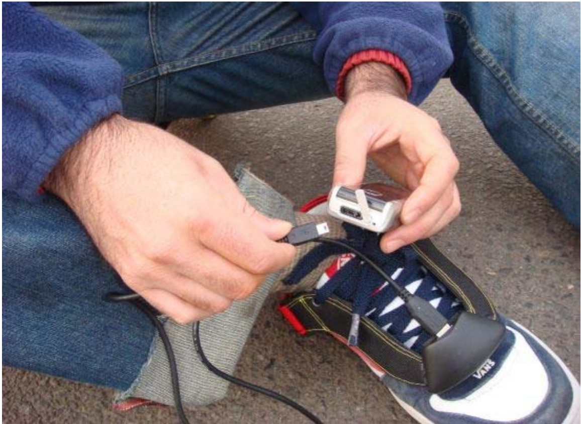
Sl. 13 Prototip tenisice s punjačem za mobitel
