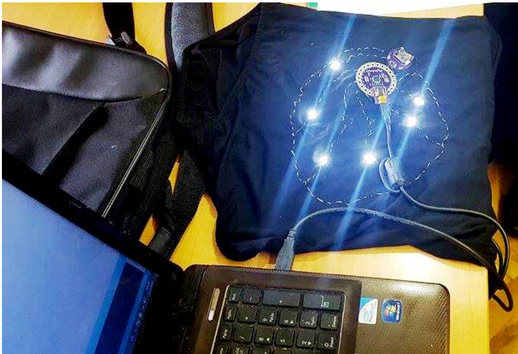
Sl. 30 Prebacivanje programa na LilyPad i probni rad programa
