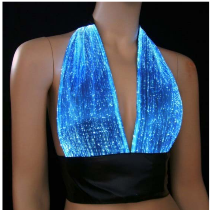
Sl. 7 Odjeća s optičkim vlaknima
