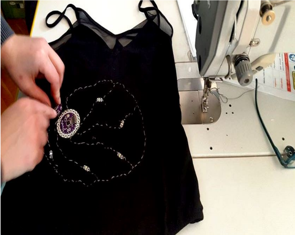
Sl. 27 Ušivanje baterijskog nosača
