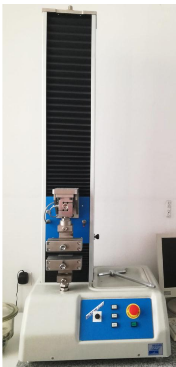
Slika 8. Dinamometar MESDAN-LAB Strength Tester
