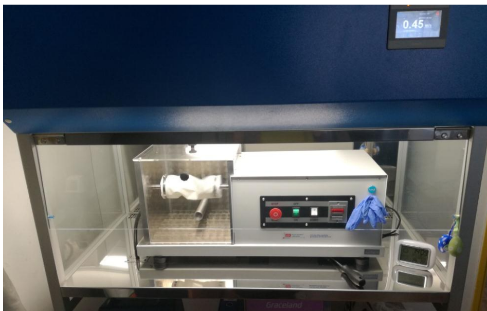
Slika 7. Generator tekstilnih čestica s mjerачem veličine čestica od 0,3 do 25 \mu\text{m}
