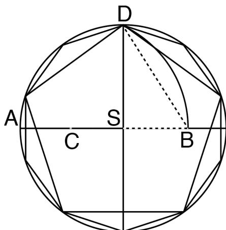
*Slika 7: Konstrukcija pravilnog peterokuta i pravilnog deseterokuta sa zadanim radijusom opisane kružnice*
