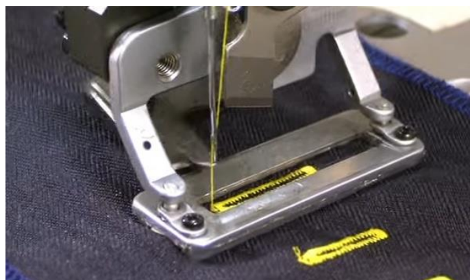
Sl. 2. Šivaći automat za izradu rupica[6]
