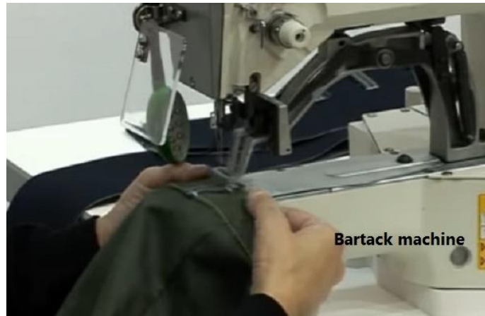
Sl. 1. Šivaći automat za izradu zapora [5]
