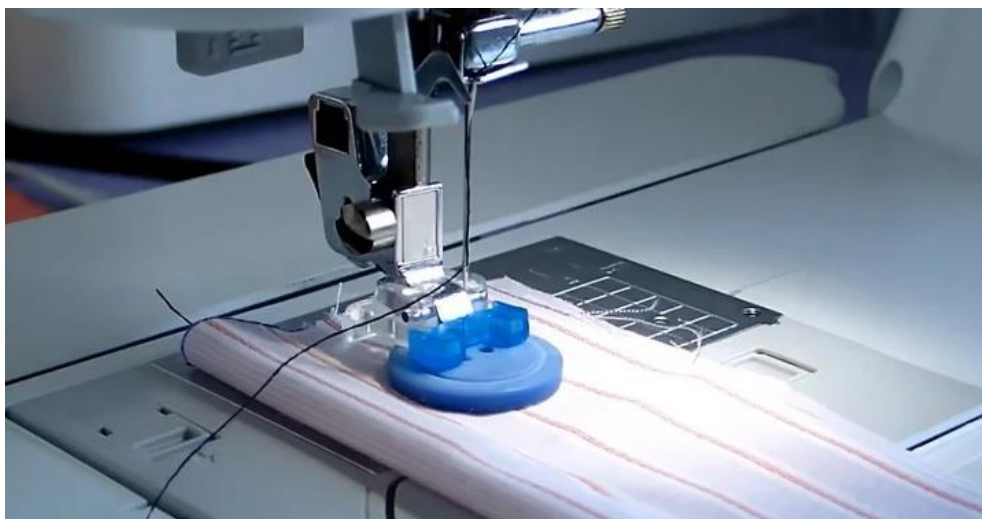
Sl. 3. Šivaći automat za našivanje gumbi [7]
