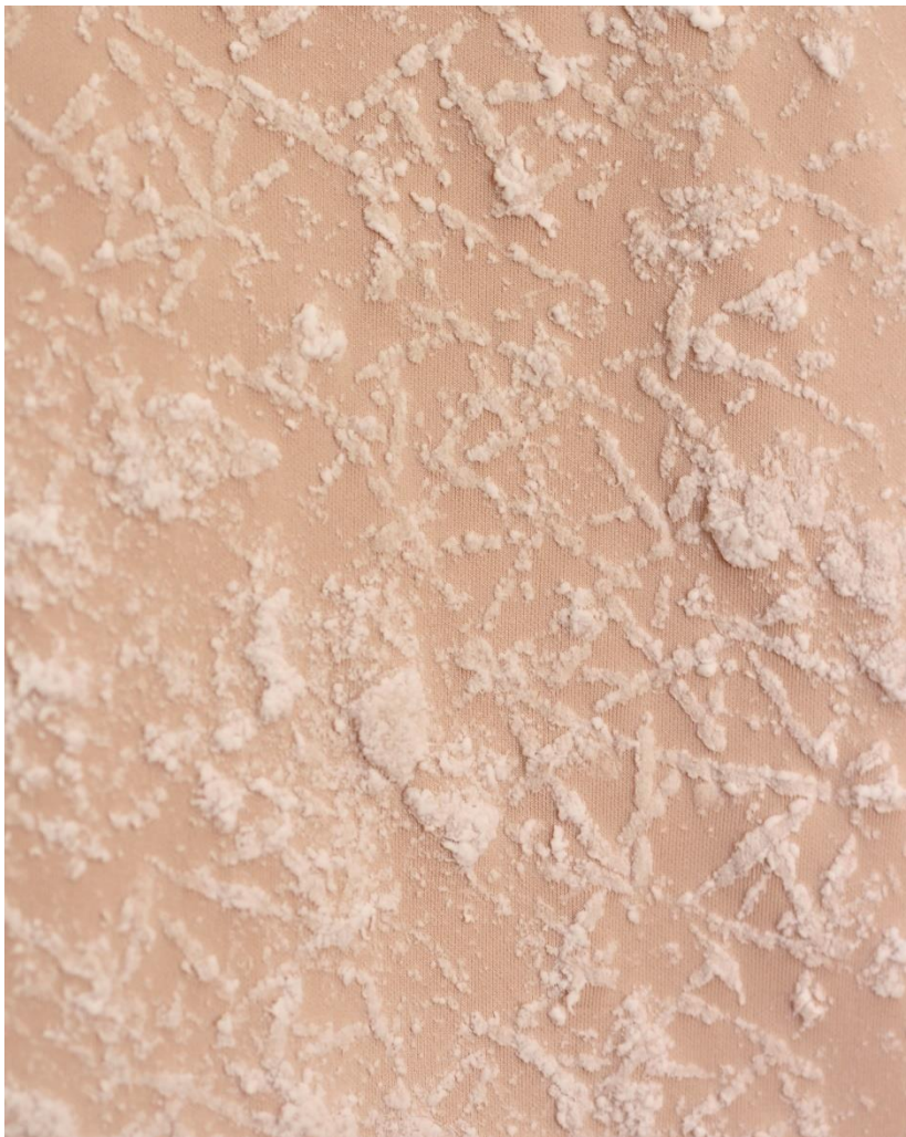
Slika 15. Prikaz bubrećeg tiska na neoprenu
