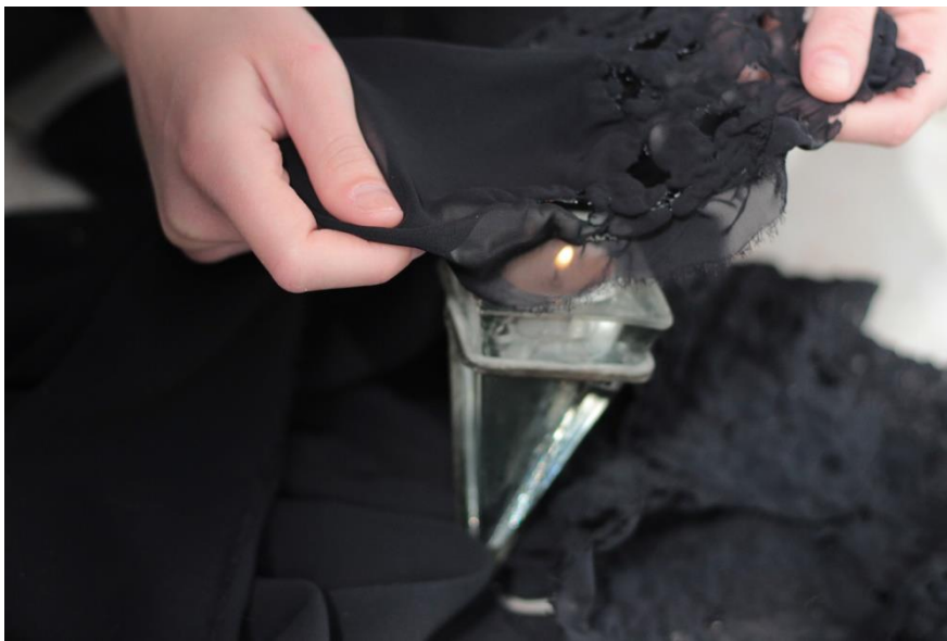
Slika 11. Prikaz istraživanja svojstava materijala paljenjem
