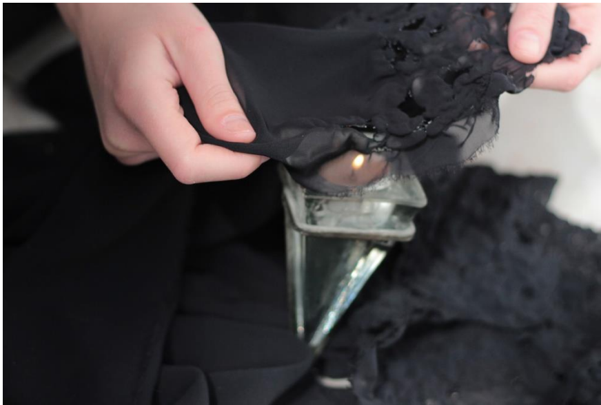
Slika 11. Prikaz istraživanja svojstava materijala paljenjem
