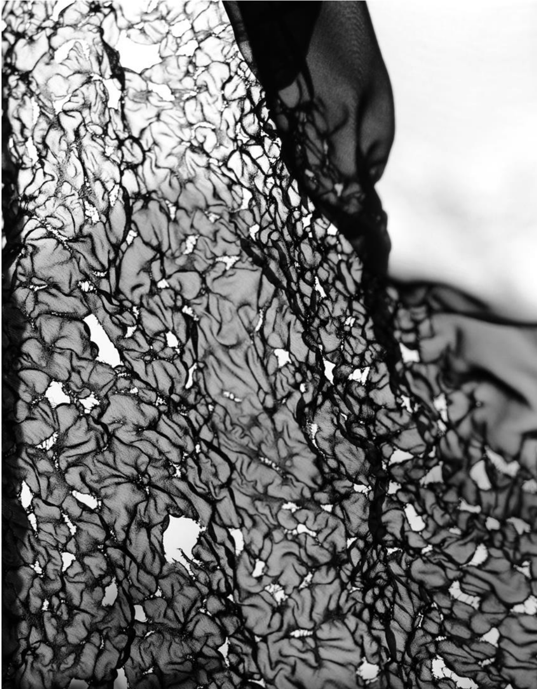
Slika 14. Prikaz poliestera nakon intervencije paljenjem
