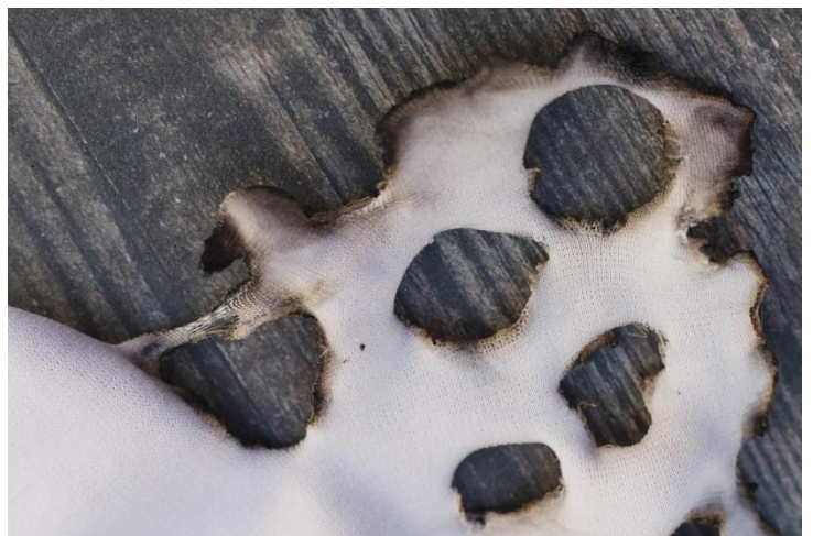
Slika 10. Prikaz pamučnog pletiva nakon intervencije paljenjem
