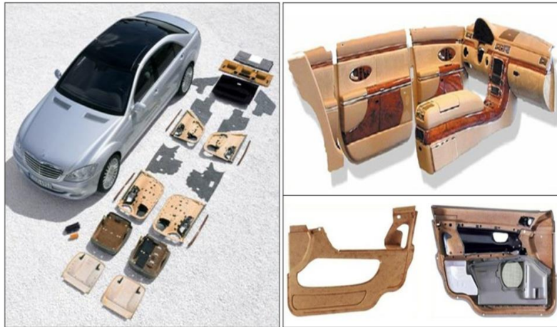
Slika 2.4.2.1. Automobilski dijelovi načinjeni od biokompozitnih materijala [22].
