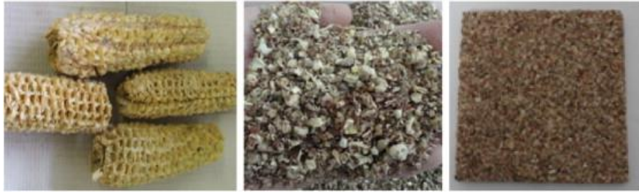
Slika 2.4.3.6. Kukuruzni klip (lijevo), mljeveni kukuruzni klip (u sredini) panel (desno) [24].
