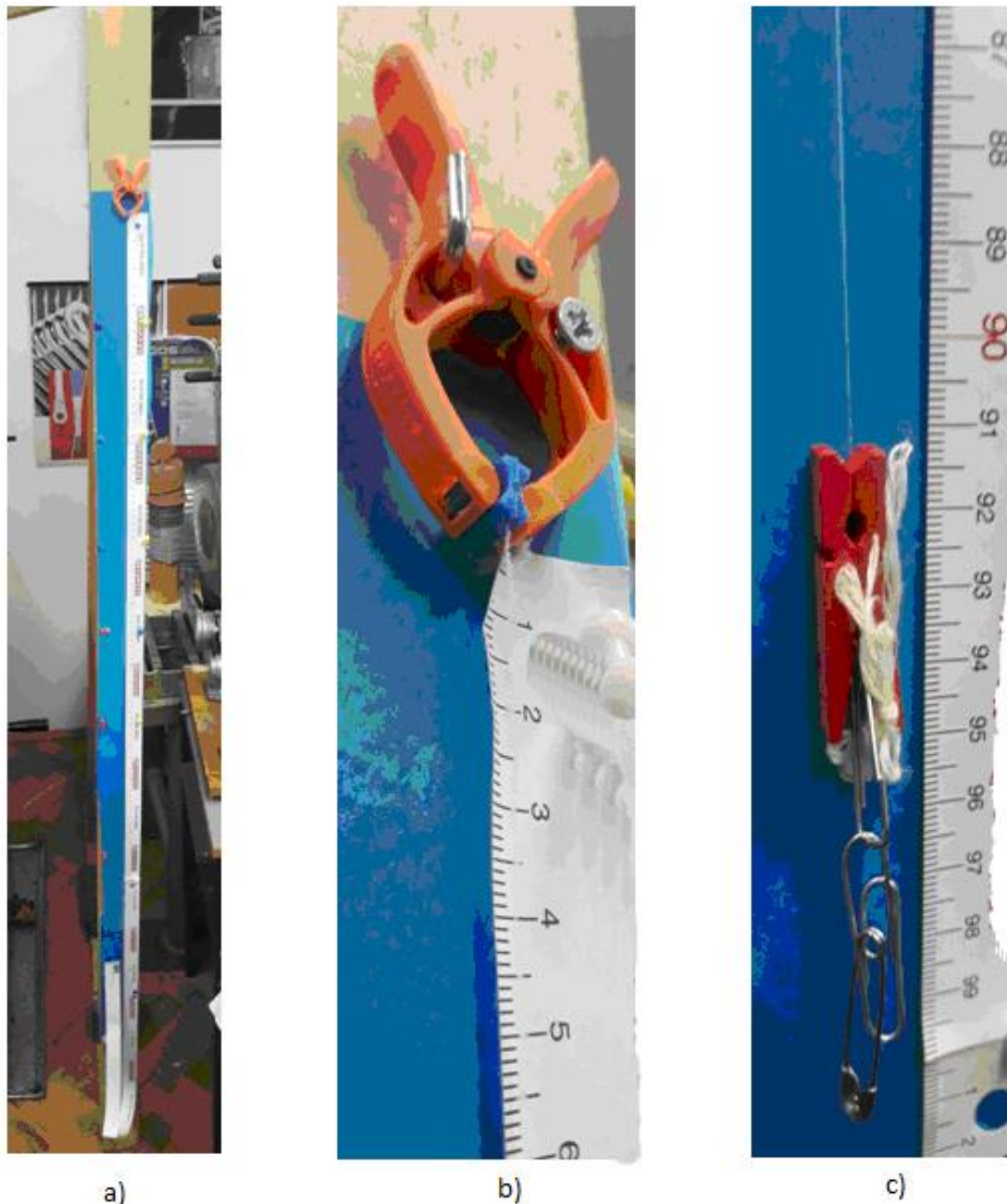
Sl.6.-1 Mjerenje utroška niti u očici: a) stalak za mjerenje utroška niti u očici, b) gornja hvatalica, c) donja hvatalica s opterećenjem
