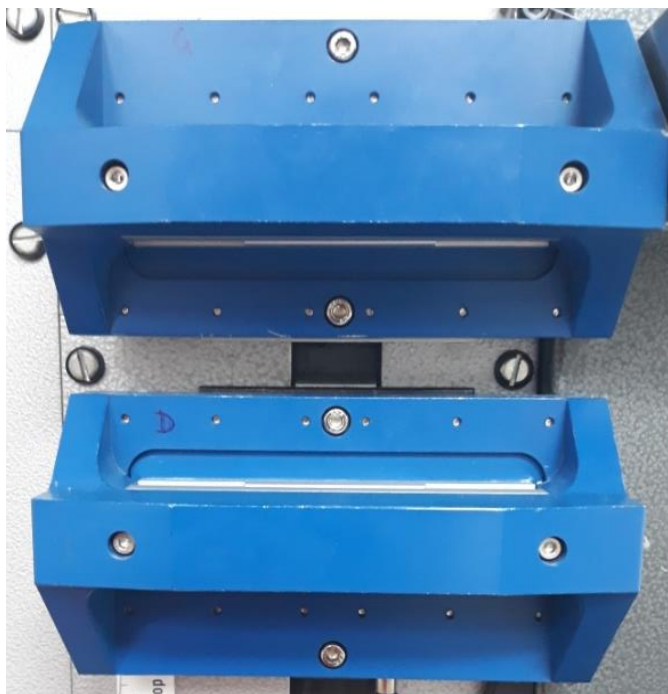
Sl.7.-2 Dinamometar za trganje uzoraka pletiva: a) radno polje i b) razmak između hvatalica
