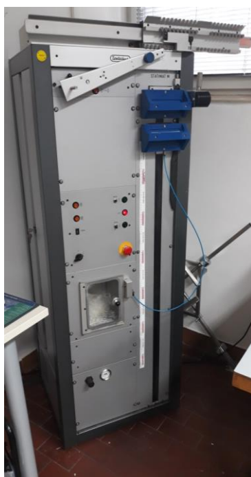
Sl.7.-2 Dinamometar za trganje uzoraka pletiva: a) radno polje i b) razmak između hvatalica
