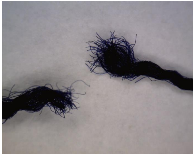
Sl. 26. Prekinuta nit pređe izvađene iz tkanine
