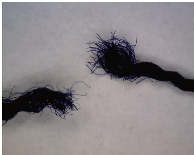
Sl. 26. Prekinuta nit pređe izvađene iz tkanine
