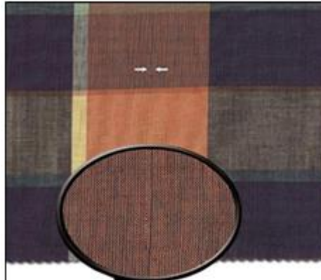
Sl. 5. Pogreška u tkanini radi oštećenja brda [8]
