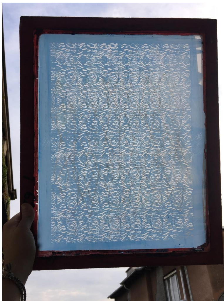
Sl.15. Šablona s apstraktnim motivom “val“(u kontralihtu radi vidljivosti uzorka) [14]
