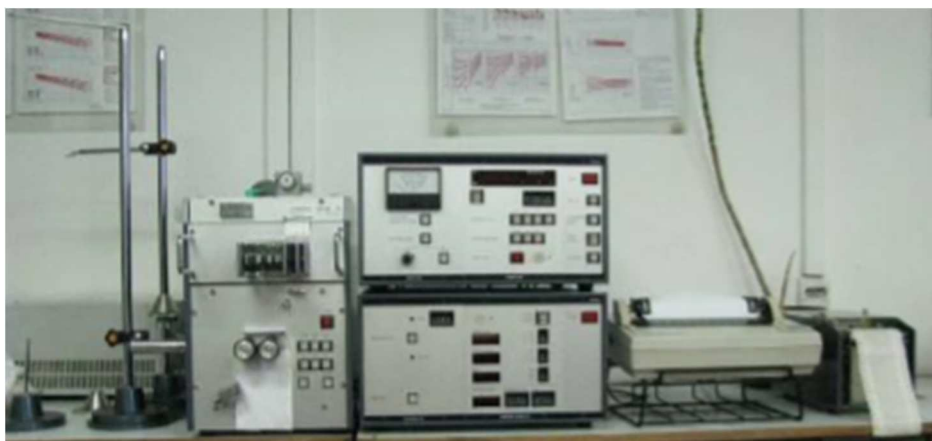
Slika 8. Uređaj za ispitivanje nejednolikosti tt. Keisokki
