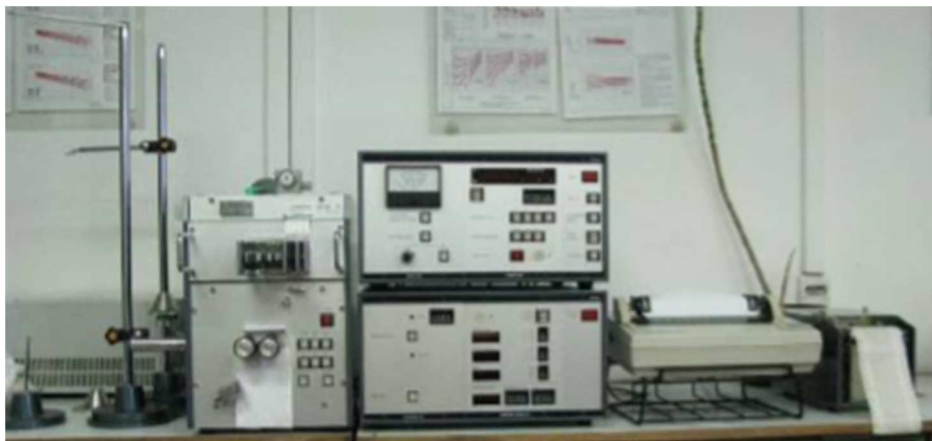
Slika 8. Uređaj za ispitivanje nejednolikosti tt. Keisokki
