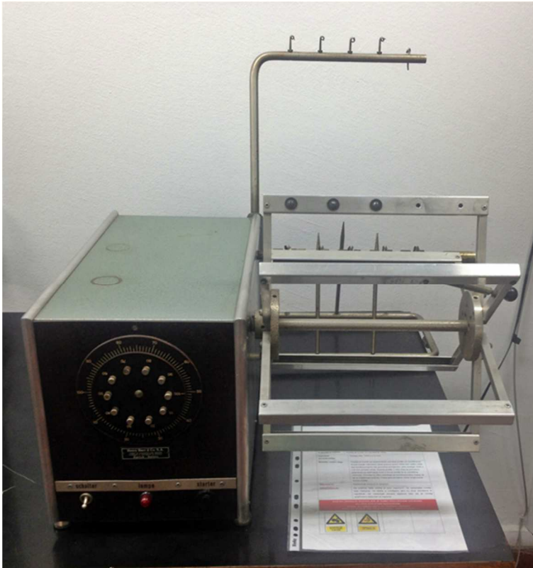
Slika 5. Vitlo za odmatanje pređe određene duljine
