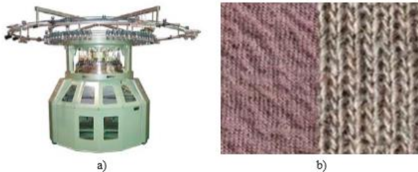
Slika 5. Kružnopletači dvoiglenični stroj tvrtke Monarch Knitting Machinery s dvije finoće igala; a) stroj M-9MEQG i b) uzorak pletiva koji se izrađuje na stroju; na licu i naličju vide se dvije bitno različite gustoće pletiva [13]
