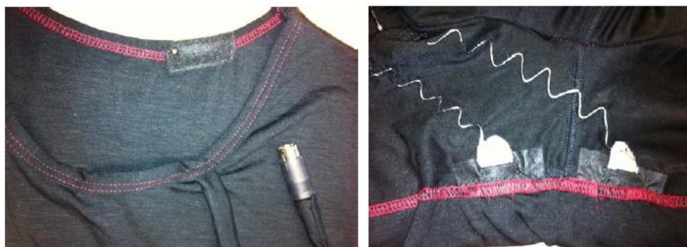
Slika 28 Slika temperaturnog senzora sa tekstilnom podstavom (lijevi dio slike) i dvije EKG elektrode (desni dio slike) [36]
