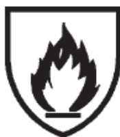
Slika 8 Simbol za zaštitu od topline i plamena prema standardu ISO 13688 [10]
