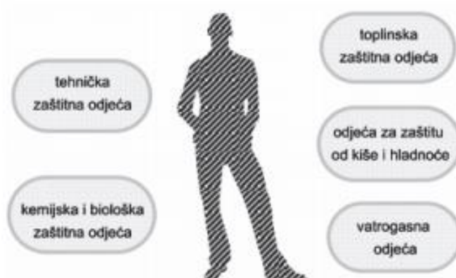
Slika 5 Podjela osobne zaštitne opreme za zaštitu tijela prema zaštitnoj funkciji. [4]
