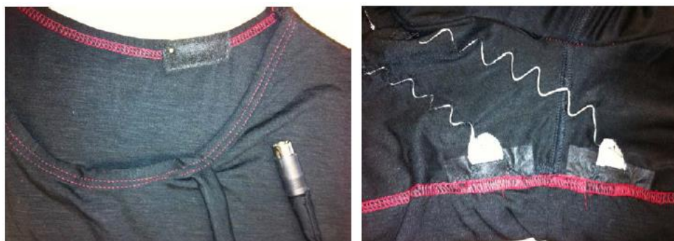
Slika 28 Slika temperaturnog senzora sa tekstilnom podstavom (lijevi dio slike) i dvije EKG elektrode (desni dio slike) [36]
