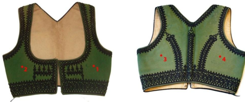
Slika 20: Mjesta na kojima su provedena spektroskopska mjerenja na osnovnoj tkanini
