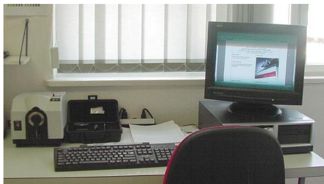
Slika 13: Remisijski spektrofotometar Spectraflash SF 300, tt. Datacolor
