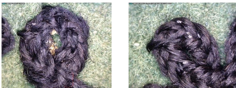
Slika 16: Mikroskopske slike: a) prljavštine, b) čestica prašine (povećanje 200x)
