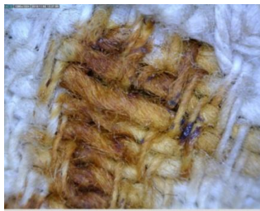
Slika 39: Mikroskopska slika hrđe na podstavi
