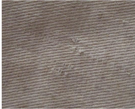
Slika 37: Oštećenje u vezu podstave
