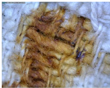
Slika 39: Mikroskopska slika hrđe na podstavi
