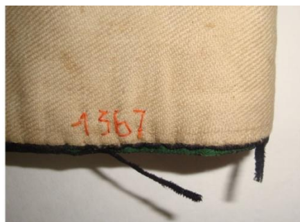
Slika 41: Paspul traka; a) oštećenje u obliku otvora na traci, b) oštećenje u obliku prekida trake
