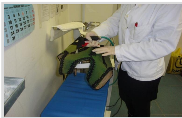
Slika 17: Čišćenje upotrebom komprimiranog mlaza zraka
