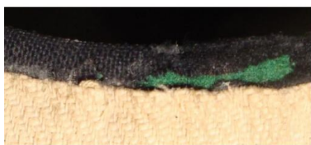
Slika 41: Paspul traka; a) oštećenje u obliku otvora na traci, b) oštećenje u obliku prekida trake
