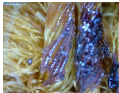
Slika 40: Mikroskopska slika smolaste mrlje
