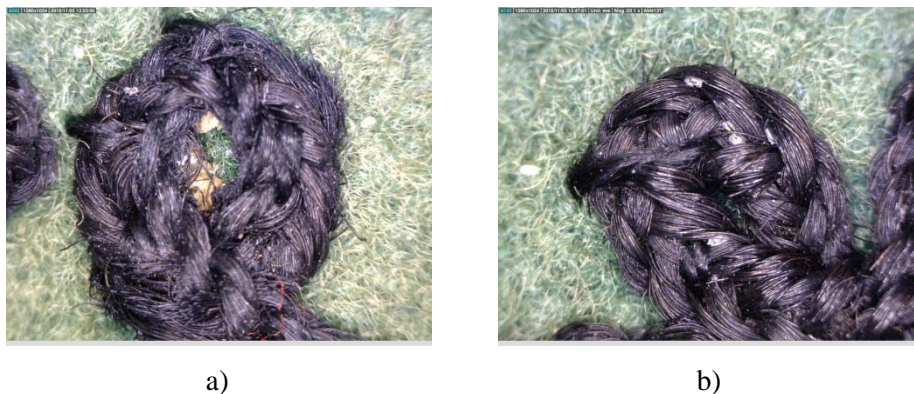
Slika 16: Mikroskopske slike: a) prljavštine, b) čestica prašine (povećanje 200x)
