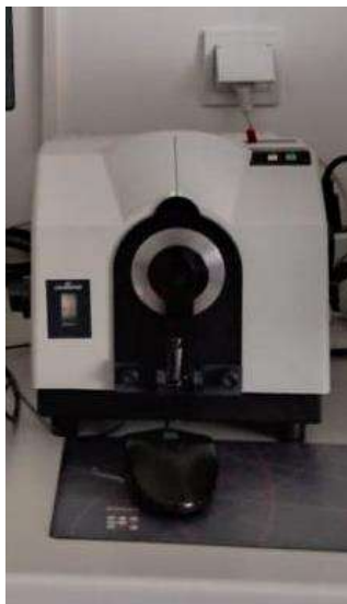
Slika 13. Remisijski spektrofotometar Spectraflash SF 300 (Datacolor)
