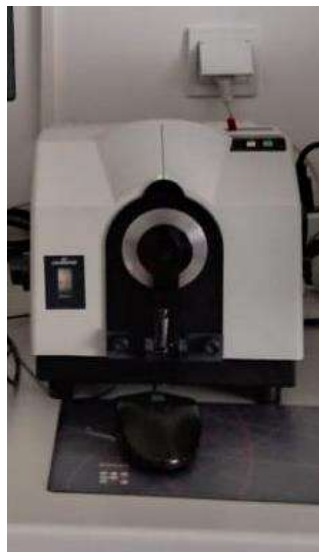
Slika 13. Remisijski spektrofotometar Spectraflash SF 300 (Datacolor)
