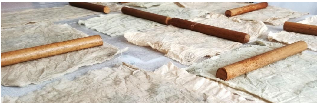
Sl. 40. Parovi tekstilnih supstrata spremni za namatanje [1]
