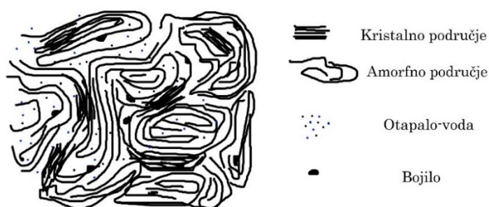
Sl. 11. Struktura vlakna [1,14]
