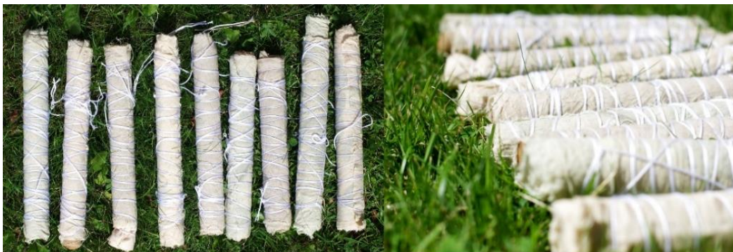
Sl. 41. Parovi tekstilnih supstrata sa biljem namotani i pričvršćeni na drveni valjak [1]
