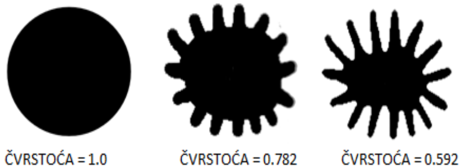
Slika 36 Primjeri kompaktnosti oblila
