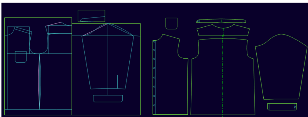
Slika 30 Temeljna konstrukcija muške košulje
