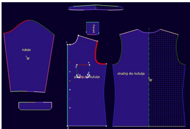
Slika 40 Definiranje segmenata krojnih dijelova košulje koji se spajaju
