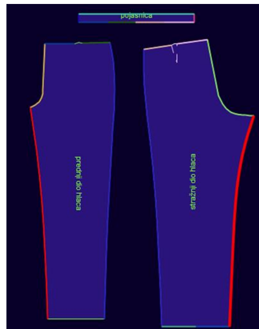
Slika 41 Definiranje segmenata krojnih dijelova hlača koji se spajaju
