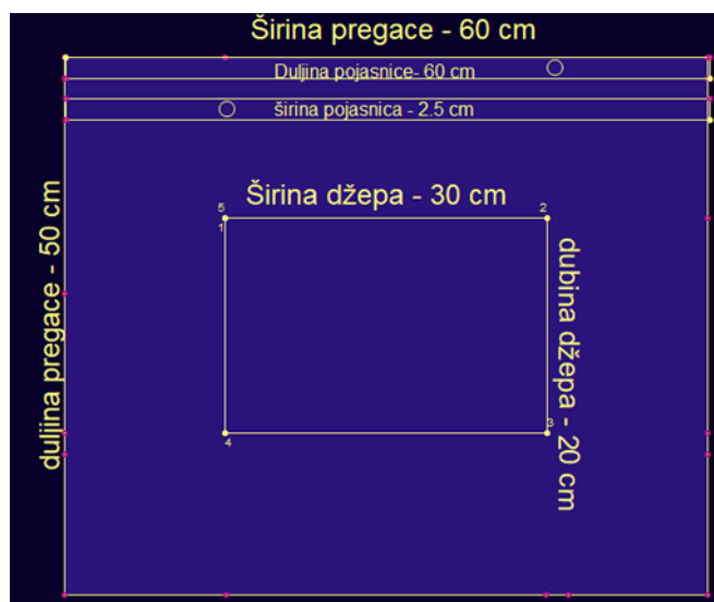
Slika 32 Konstrukcija temeljnog kroja ugostiteljske pregače
