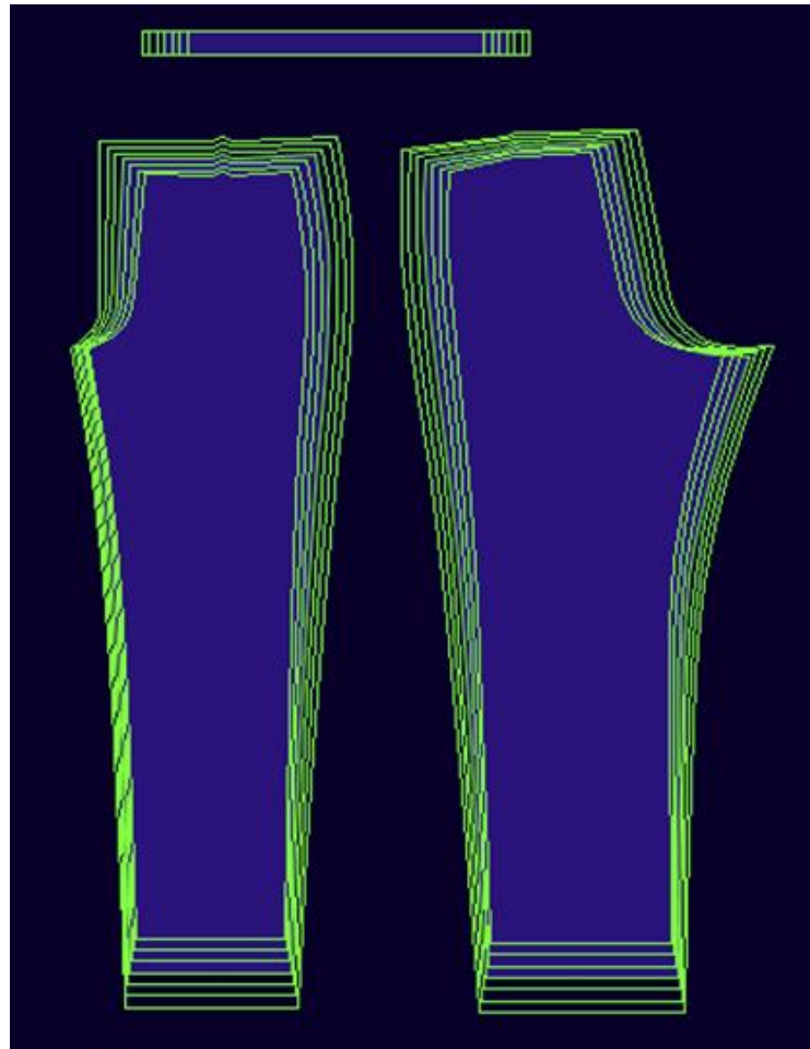
Slika 69 Rezultati gradiranja muških hlača
