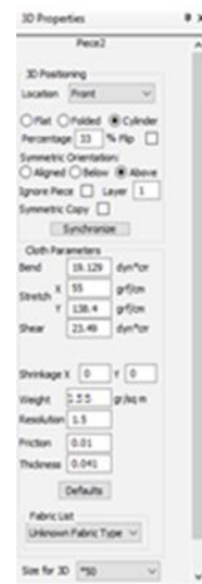
Slika 54 Definiranje vrijednosti fizikalnih i mehaničkih parametara za košulju-materijal 1
