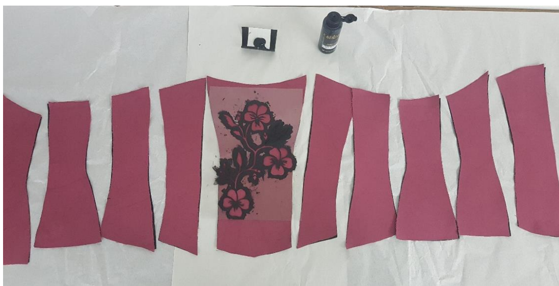
Slika 37. krojni dijelovi crvenog korzeta spojeni s flizelinom, u procesu tiska, prije spajanja, autor fotografije: Petra Anić-Božić
