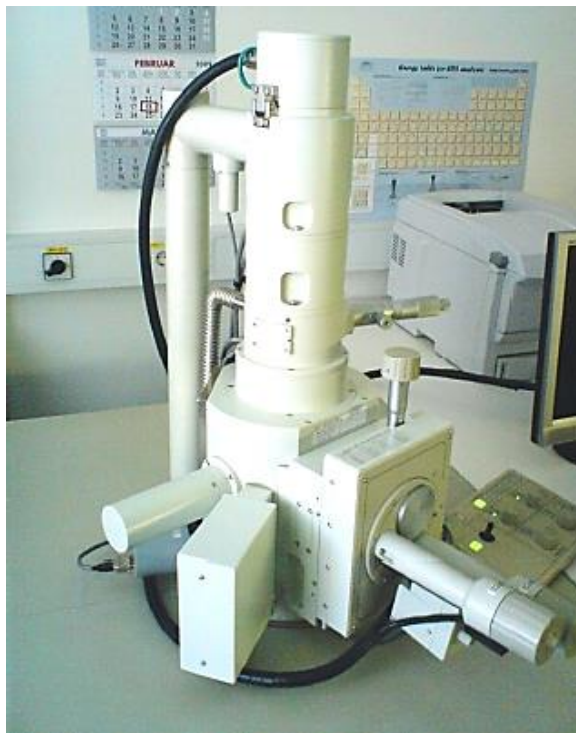
Slika 31. Prikaz pretražnog elektronskog mikroskopa, Jeol LV-6060 [80]
