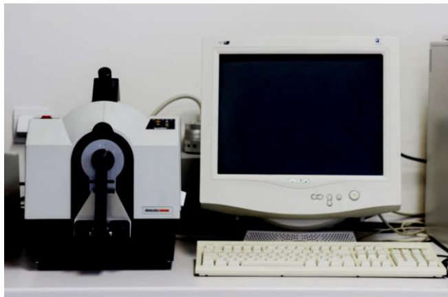
Slika 34. Remisijski spektrofotometar DataColor SP600+ CV UV [81]
