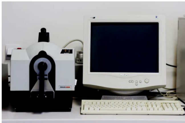
Slika 34. Remisijski spektrofotometar DataColor SP600+ CV UV [81]
