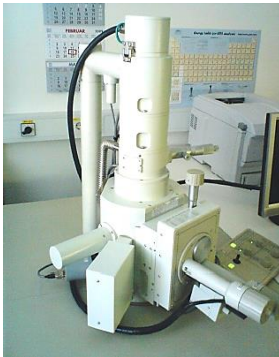
Slika 31. Prikaz pretražnog elektronskog mikroskopa, Jeol LV-6060 [80]
