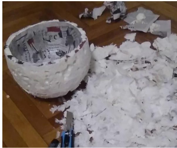
Sl. 18. Proces rezanja viška poliuretanske pjene
