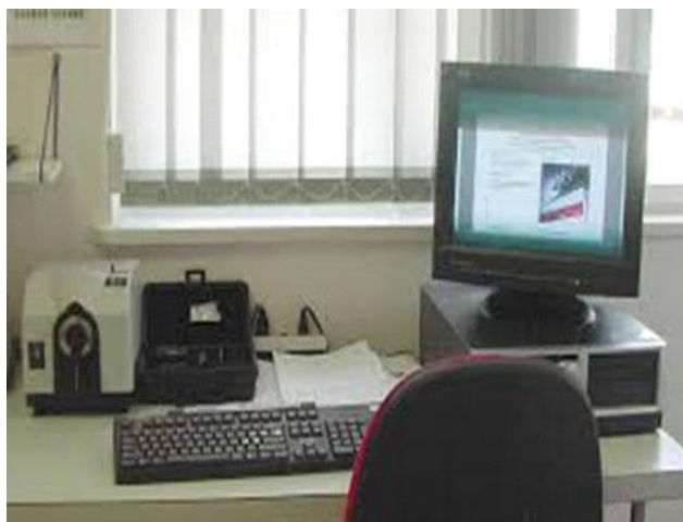
Slika 24. Remisijski spektrofotometar Spectraflash SF 300 , Datacolor
