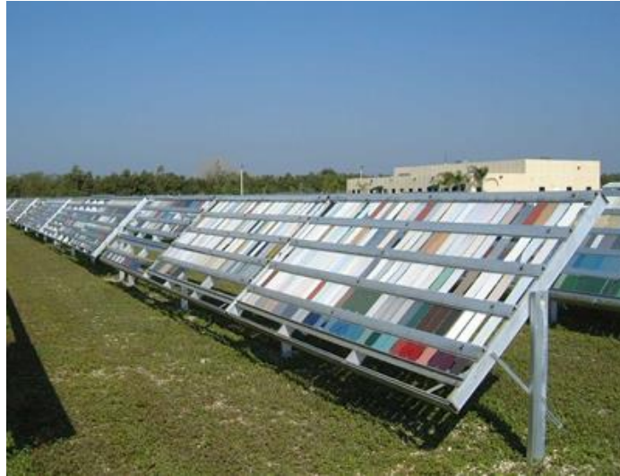
Slika 10: Prikaz naprava i načina izlaganja uzoraka prirodnom starenju[24]
