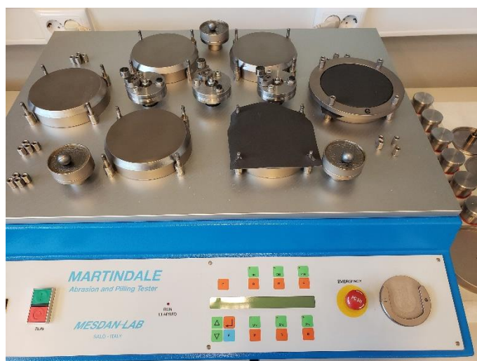
Slika 14: Habanje na aparatu prema Martindaleu (Zavod za vlakna, materijale i ispitivanje tekstila)
