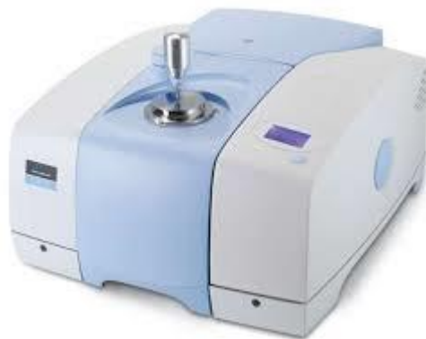
Slika 13: Perkin Elmer Spectrum 100 FTIR-ATR [27]
