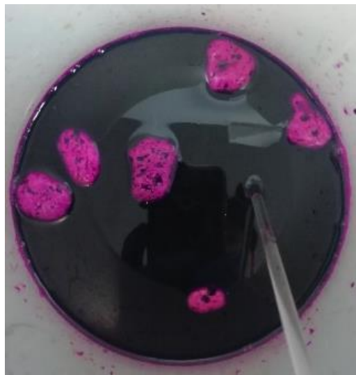
Slika 11. Namakanje vulkanskog kamena u otopini \text{KMnO}_4
