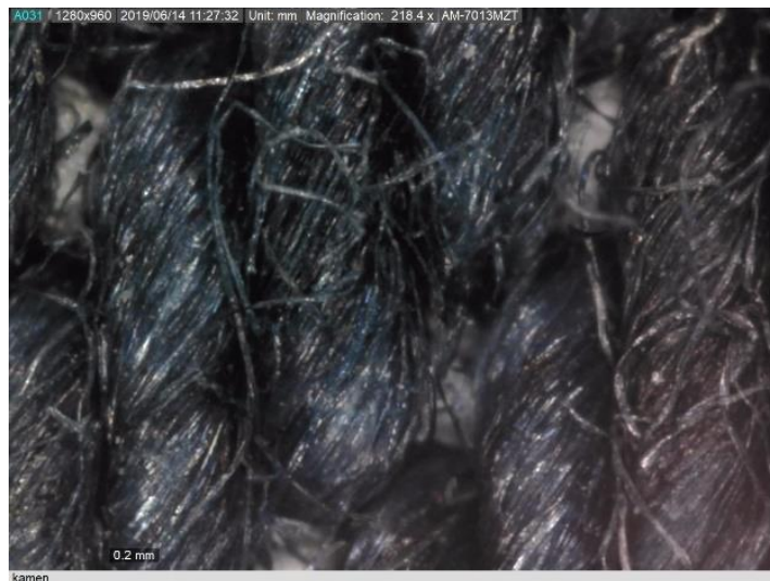
Slika 33. Uzorak obrađen vulkanskim kamenom i KMnO 4 : a) povećanje 55x; b) povećanje 230x
