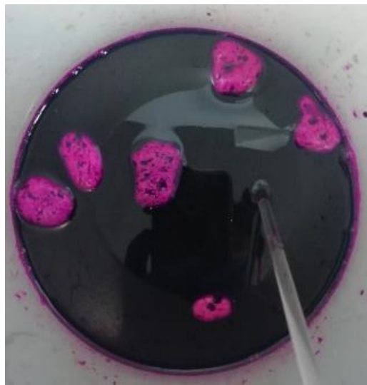
Slika 11. Namakanje vulkanskog kamena u otopini \text{KMnO}_4
