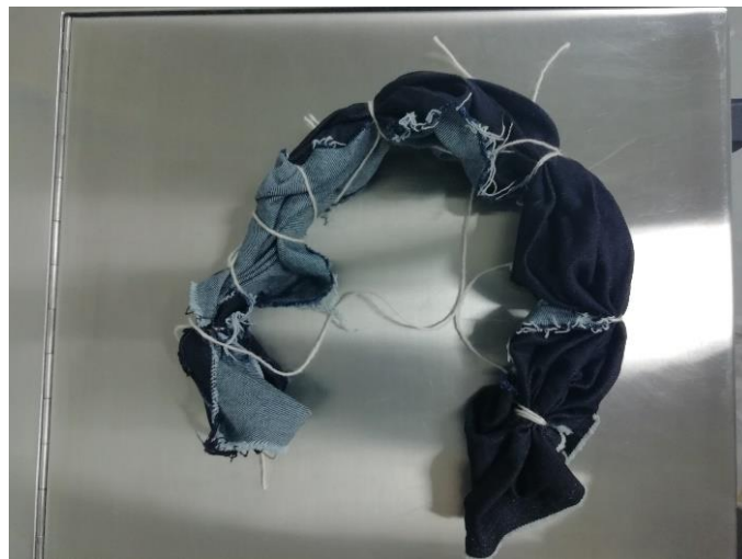
Slika 17. Način vezanja materijala kako bi se postigao efekt
