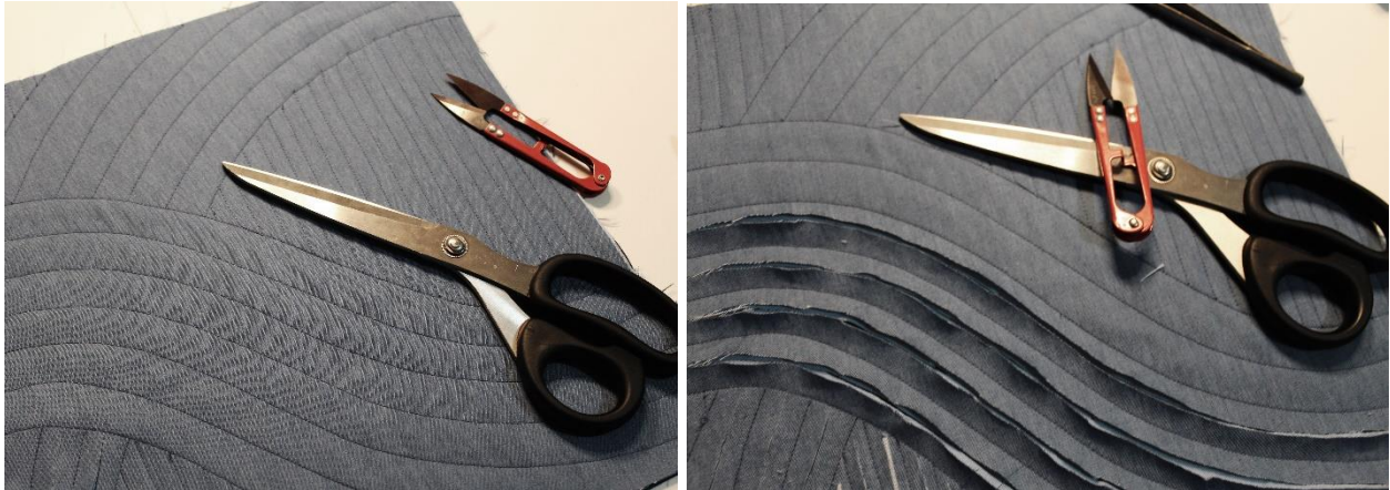
Sl. 30. Prošiveni uzorak tekstila i način izrezivanja slojeva
