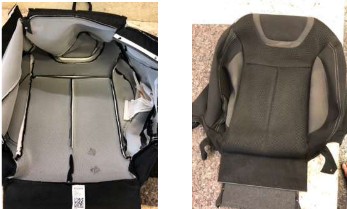
Slika 8. Vanjski i unutarnji izgled pokrivnog kompozitnog dijela sjedala
