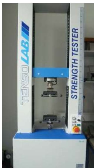
Slika 12. Kidalica Tensolab 3000, tt. Mesdan S.p.A., Italija
