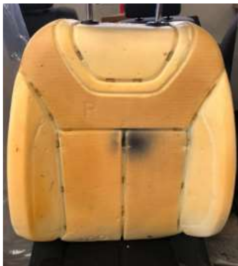
Slika 5. Izgled sjedala bez pokrivnog dijela (poliuretanska ispuna)
