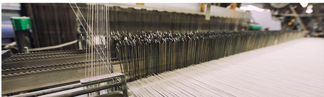
Sl. 17. Lamele na tkalačkom stroju [25]
