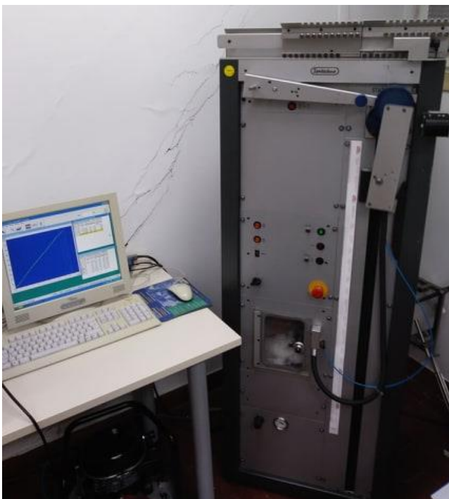
Sl. 22. Dinamometar Statimat M – tt. Textechno, Njemačka
