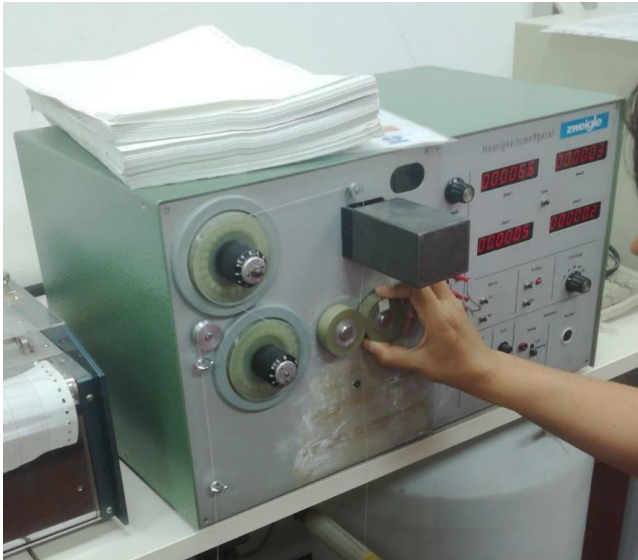
Sl. 21. Uređaj za mjerenje dlakavosti pređe – tip G tt. Zweigle
