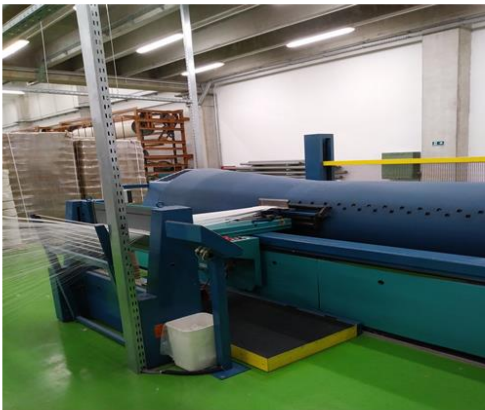
SI. 7. Sekcijska snovaljka, Benninger BEN-TRONIC 3000 (Tvornica tekstila Trgovišće)
