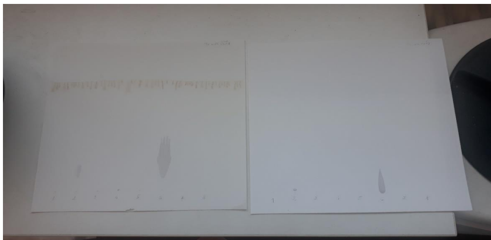
Slika 42: Razvijeni kromatogram s uzorcima 1-8 nakon vizualizacije parama NH 3
