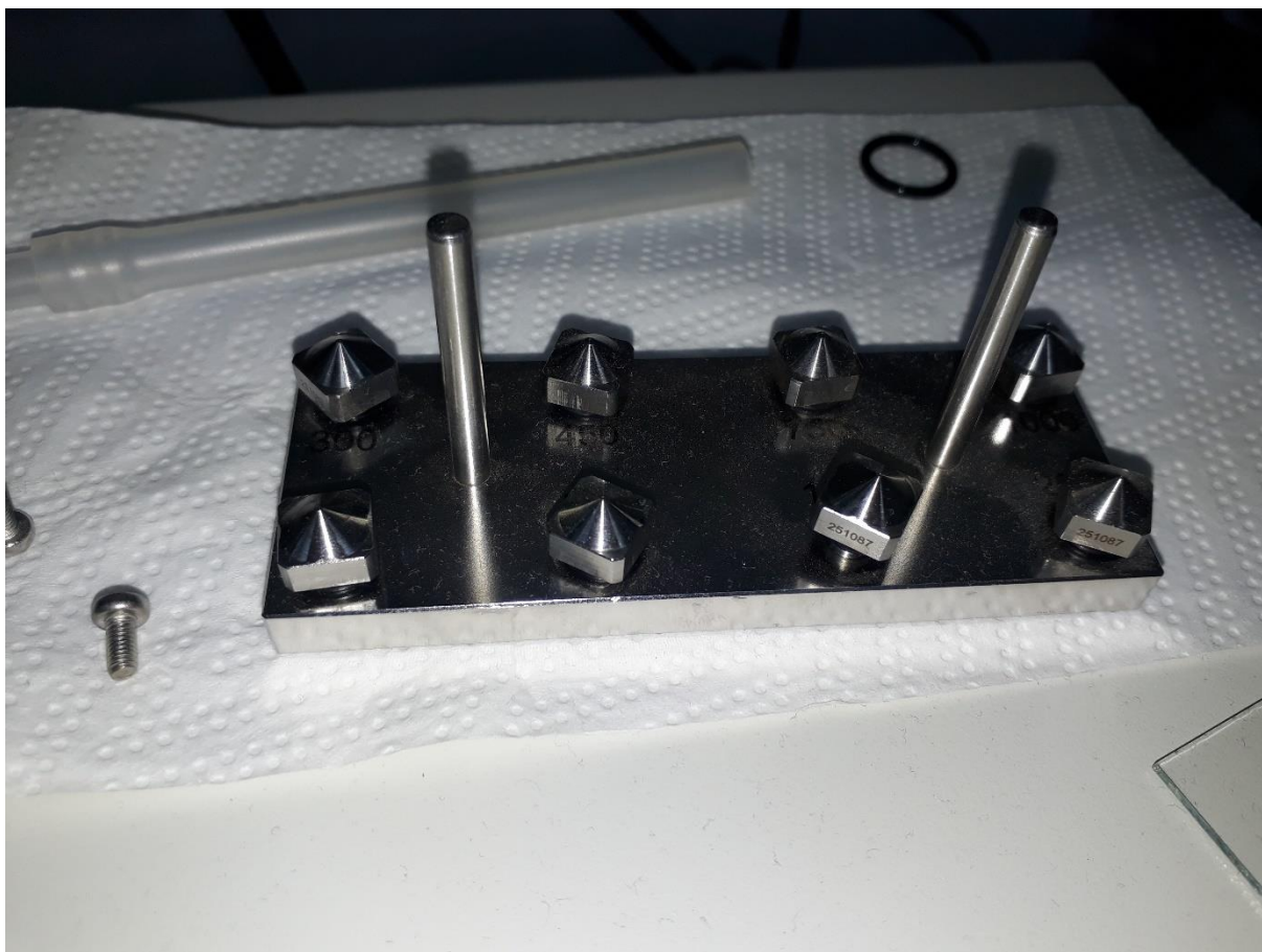
Slika 31: Nastavci za promjer mikrokapsula
