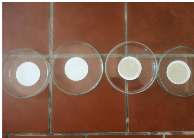
Slika 12. Rezultati određivanja suspendiranih tvari u vodi za ljudsku potrošnju (lijevo) i u površinskoj vodi (desno)
