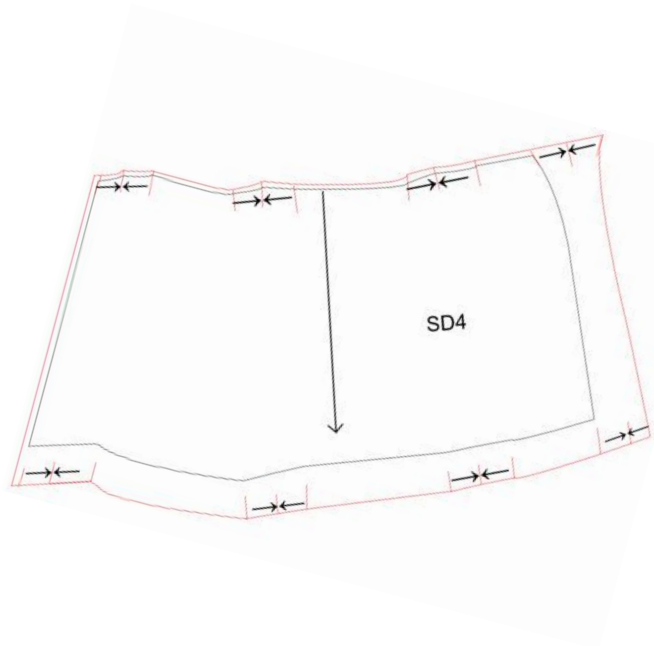
Slika 55. Dodani dodaci za šav, linije smjera osnove za tkaninu i smjer spajanja nabora na krojni dio SD4. Za šav za porub je dodano 5cm, a s podstave je oduzeto 5 cm kako bi se rub haljine “vukao” prema unutrašnjem dijelu kao što je i na skici modela.
