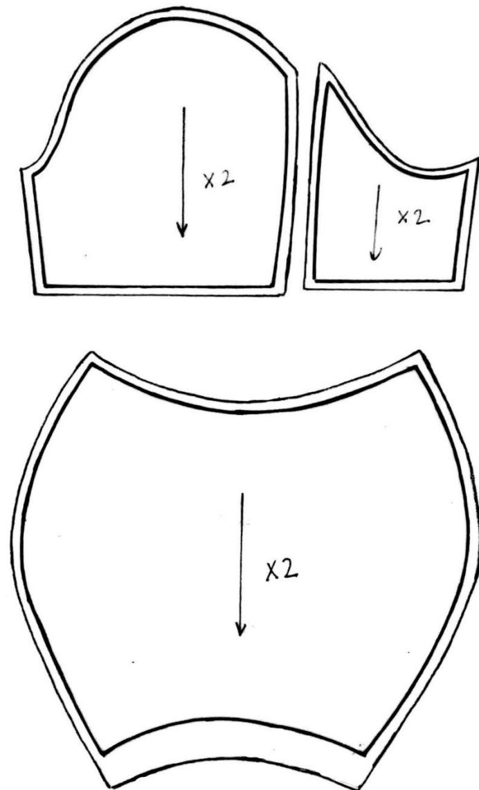
Slika 42. Krojni dijelovi rukava sa šavnim dodacima
