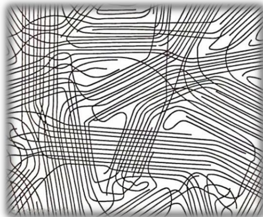
SI.5. Shematski prikaz rasporeda makromolekula u polietilenu [4]
