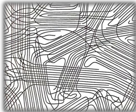
SI.5. Shematski prikaz rasporeda makromolekula u polietilenu [4]
