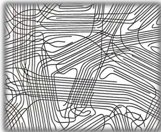
SI.5. Shematski prikaz rasporeda makromolekula u polietilenu [4]
