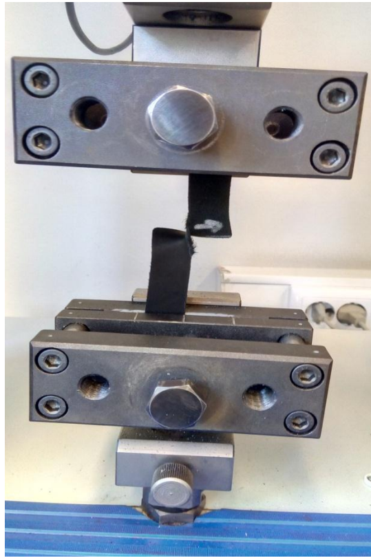
Slika 21. Provedba ispitivanja metodom jednostrani zarez.
