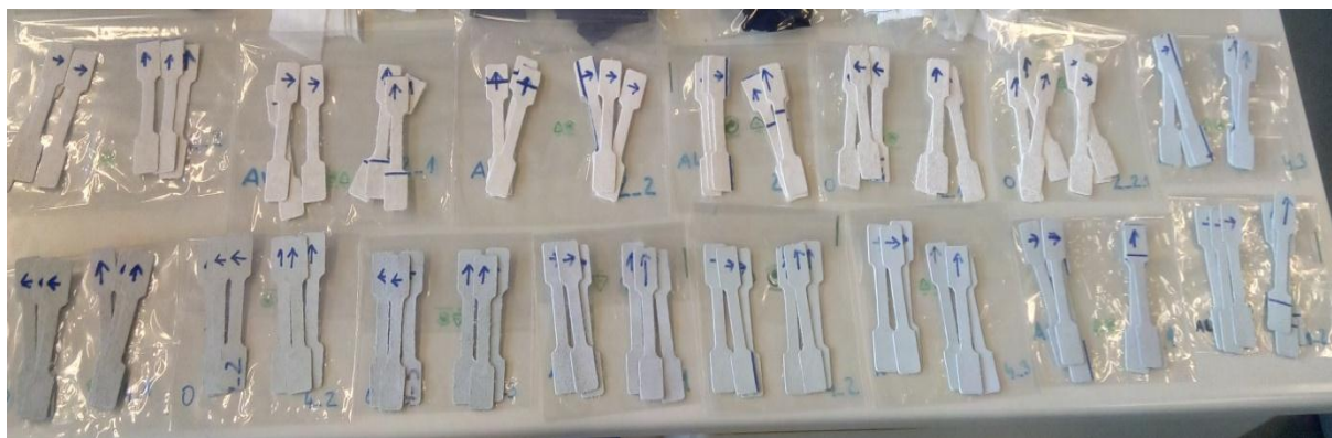
Slika 17. Ispitne epruvete za određivanje prekidne čvrstoće
