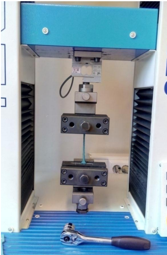
Slika 18. Kidalica za vrijeme rada Slika 19. Izgled epruvete nakon prekida.
