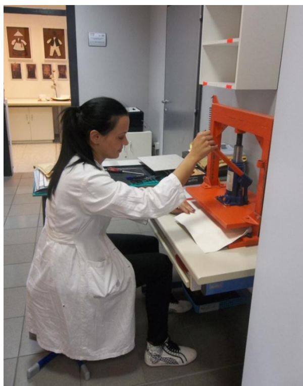
Slika 16. Izrezivanje ispitnih epruveta primjenom pritisne preše i rezača
