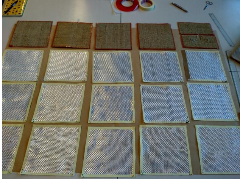
Slika 8. Izrezani komadi staklenih i lanenih ojačala
