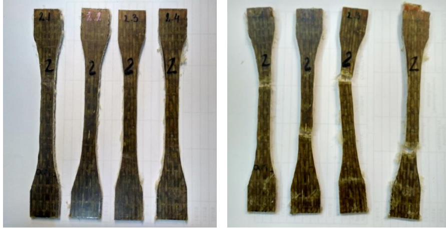
Slika 35. Epruvete kompozitne ploče L1_I. za ispitivanje vlačne čvrstoće prije i poslije ispitivanja
