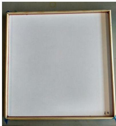
Slika 11. Kalup za izradu kompozitnih ploča- podloga i okvir
