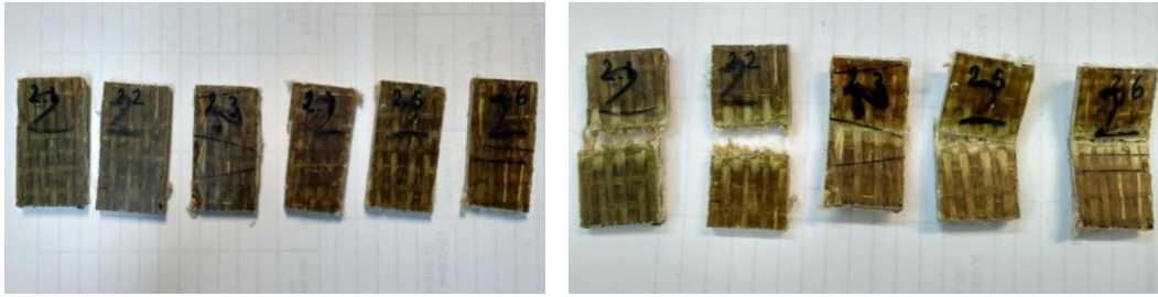
Slika 50. Epruvete kompozitne ploče L1_I. prije i poslije ispitivanja međuslojne tvrdoće
