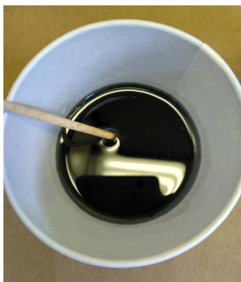
Slika 13. Priprema matrice u papirnoj čaši
