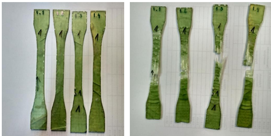
Slika 33. Epruvete kompozitne ploče S1_IV. za ispitivanje vlačne čvrstoće prije i poslije ispitivanja
