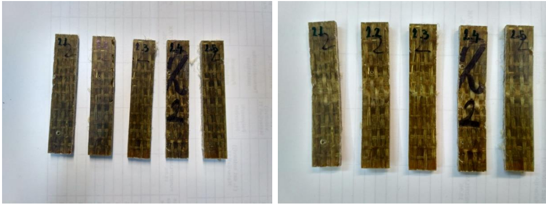
Slika 43. Epruvete kompozitne ploče L1_I. za ispitivanje savojne čvrstoće prije i poslije ispitivanja
