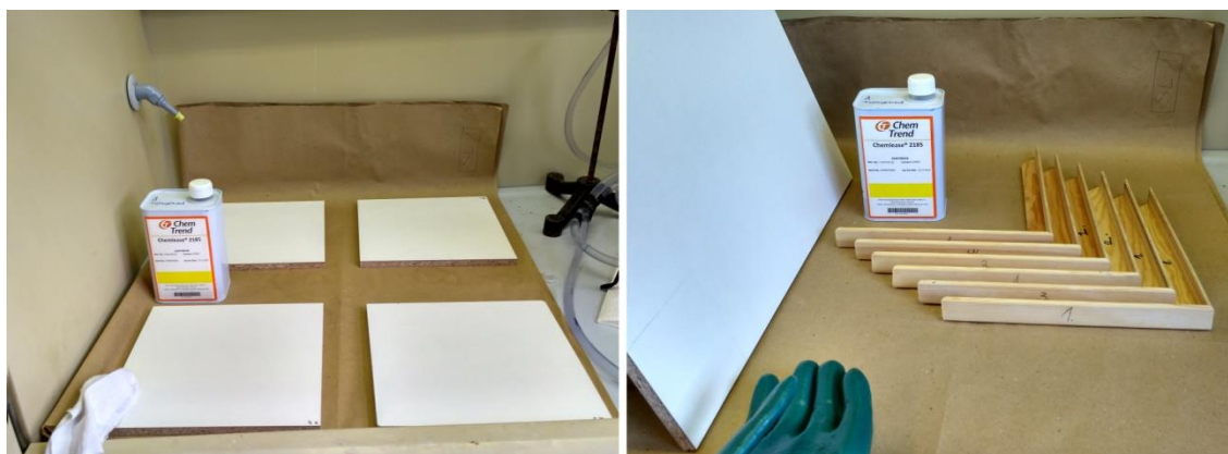
Slika 12. Premazivanje kalupa sredstvom za odvajanje
