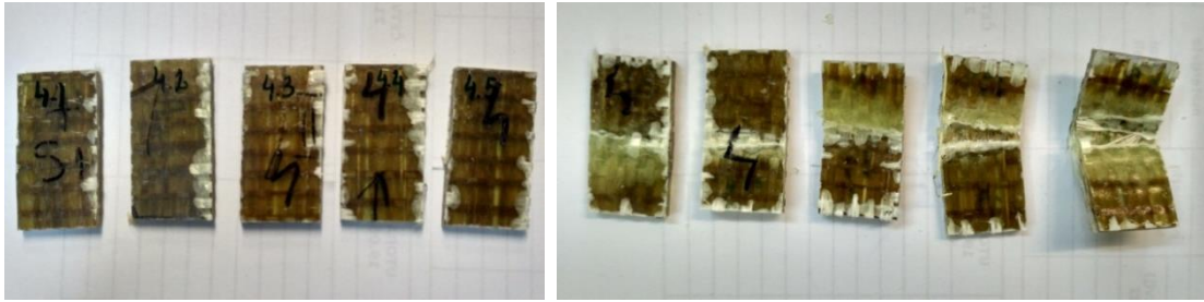
Slika 52. Epruvete kompozitne ploče S1L1_II. prije i poslije ispitivanja međuslojne tvrdoće
