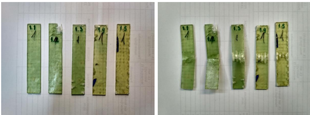
Slika 41. Epruvete kompozitne ploče S1_IV. za ispitivanje savojne čvrstoće prije i poslije ispitivanja
