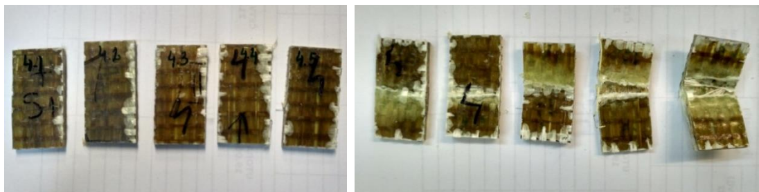
Slika 52. Epruvete kompozitne ploče S1L1_II. prije i poslije ispitivanja međuslojne tvrdoće
